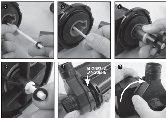
de manière à ce que celui-ci soit bien inséré dans la douille de la turbine. Les languettes d'ouverture du couvercle devraient s'insérer dans les fentes correspondantes de la face avant de la pompe.
